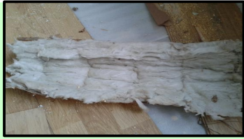
Eural 170601 asbesthoudend isolatiemateriaal
